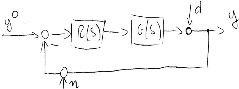
con  $G(s) = A(s) \cdot P(s) \cdot T(s)$  — dinamica del processo "strumentato"
