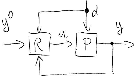
• Il regolatore ha accesso ad una misura del disturbo e lo impiega per stabilire l'andamento di  $u(t)$
