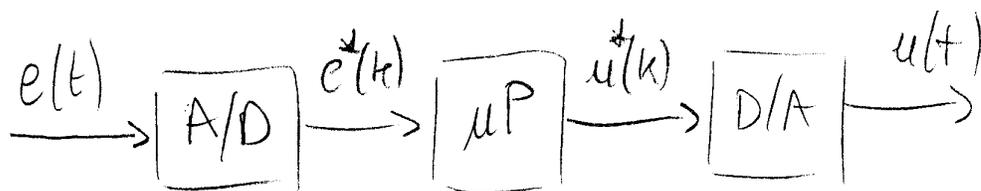
Si converte il segnale analogico in un segnale digitale, campionato ad intervalli regolari. Il segnale viene elaborato da un microprocessore per produrre il segnale di controllo  $u^*(k)$ , che viene riconvertito in un segnale digitale.
