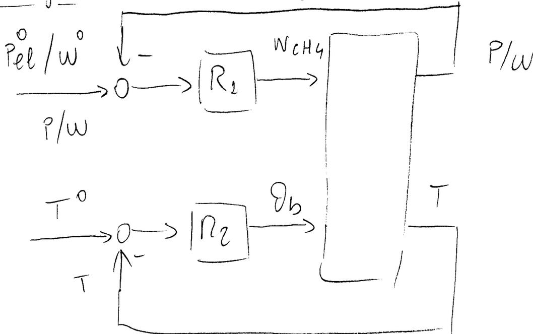
→ È possibile modulare indipendentemente il carico elettrico e quello termico; per avere capacità di controllo, una parte dei fumi caldi è bypassata al camino (basso rendimento)
