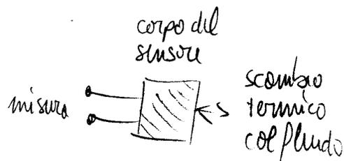
figura. Ipotizzando che la temperatura del corpo del sensore sia uniforme (ipotesi valida fino ad una certa frequenza), la dinamica tra la temperatura del fluido e la misura è analoga a quella tra temperatura esterna e temperatura interna del termoisolante
