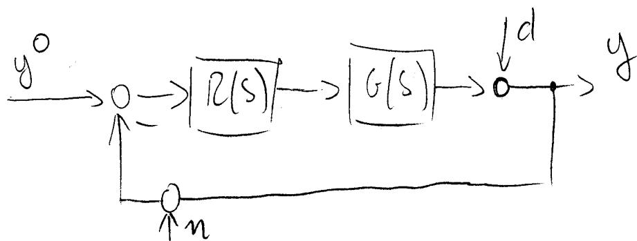
con  $G(s) = A(s) \cdot P(s) \cdot T(s)$  — dinamica del processo "strumentale"
