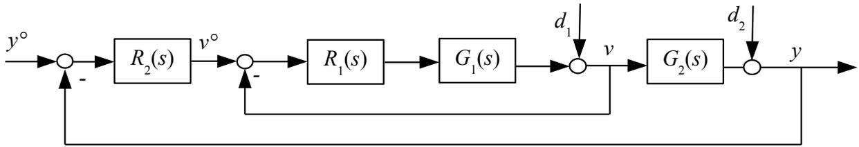
Il sistema da controllare è caratterizzato da due dinamiche  $G_1(s)$  e  $G_2(s)$  e da una variabile misurabile intermedia  $v$ , tali per cui la prima permette più facilmente della seconda di chiudere un anello di retroazione con banda elevata.
