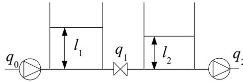
$l_1$  e  $l_2$  sono i livelli dei due serbatoi,  $A$  la sezione dei serbatoi,  $q_0$  e  $q_2$  le portate delle due pompe e  $q_1$  la portata attraverso la valvola.
