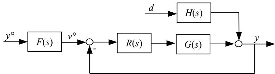
Si può ricorrere ad uno schema a due gradi di libertà con prefiltraggio del riferimento. La funzione di trasferimento tra  $v^\circ$  e  $y$  può essere approssimata dalla funzione
