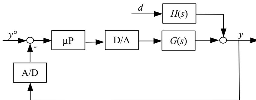
Il blocco A/D converte le misure a tempo continuo di  $y$  in quantità digitali con un periodo  $T_c$ . Il microprocessore esegue, sempre con periodo  $T_c$ , un programma basato su algoritmi di calcolo numerico che approssima la dinamica del regolatore PI progettato in precedenza. I valori calcolati sono poi convertiti in quantità analogiche dal convertitore D/A ed inviate agli attuatori del sistema.
