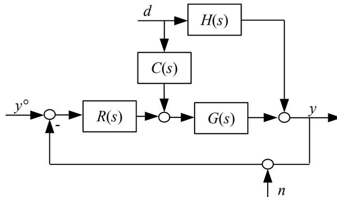
Il compensatore ideale avrebbe funzione di trasferimento  $C^*(s) = -H(s)/G(s) = -(1+0.4s)(1+0.2s)$ , mentre il compensatore statico ha funzione di trasferimento  $C(s) = -1$ .
