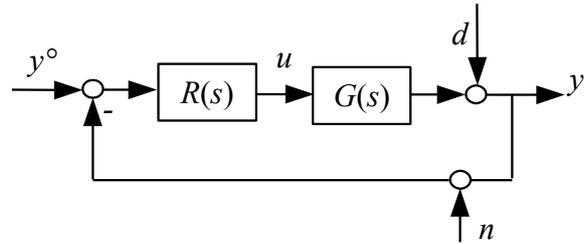
La funzione di sensitività è definita come  $S(s) = 1/(1+R(s)G(s))$ . E' la f.d.t. tra il disturbo in linea di andata  $d$  e l'uscita controllata  $y$ ; in quanto tale, il suo diagramma del modulo esprime il fattore di attenuazione dei disturbi in linea di andata che si ottiene impiegando il regolatore in retroazione  $R(s)$ .
