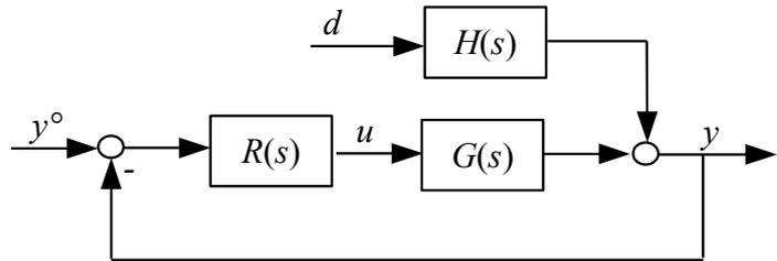
**4.1** Progettare un regolatore di tipo PI (o PID, se necessario) con una banda di  $1.5 \cdot 10^{-3}$  rad/s ed un margine di fase di almeno  $60^\circ$ .
