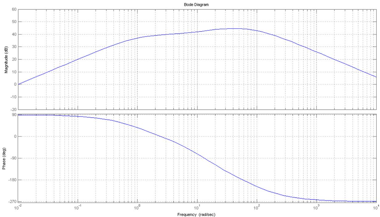
4.2 Scegliere la funzione di trasferimento  $G(s)$  in modo che segnali sinusoidali di frequenza angolare  $5 < \omega < 50$  vengano tutti amplificati di un ugual fattore dal sistema complessivo.
