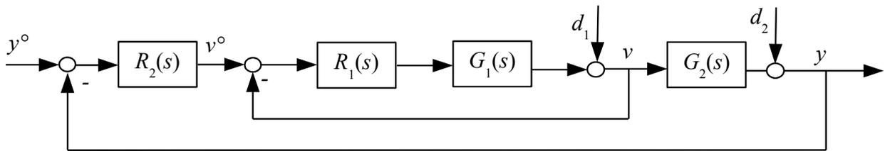
Il sistema da controllare è caratterizzato da due dinamiche  $G_1(s)$  e  $G_2(s)$ , tali per cui la prima permette più facilmente della seconda di chiudere un anello di retroazione con banda elevata.
