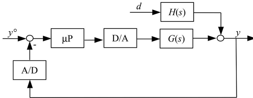
Si suppone che il set point sia già disponibile in forma digitale. Il blocco A/D è un campionatore sincrono, il blocco D/A un mantentore, il blocco  $\mu P$  rappresenta il microprocessore che calcola la variabile di controllo in modo da approssimare la dinamica del regolatore PI.
