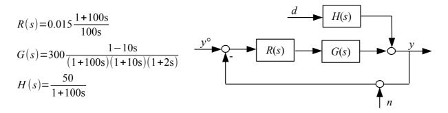
**3.1** Calcolare l'errore a transitorio esaurito a fronte di variazioni a scalino unitarie del riferimento  $y^{\circ}$  e del disturbo d.
